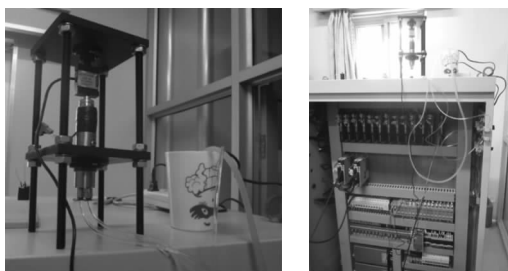
图 9 音圈促动器、液冷循环系统和控制柜
