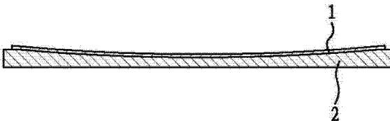
1. 一种大口径花岗岩玻璃复合式球面与非球面反射镜,其特征在于:它由光学玻璃镜胚和花岗岩镜体组成;所述的光学玻璃镜胚和花岗岩镜体牢固地粘合成为一个整体。
