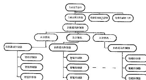
1、一种天文望远镜主动光学主动支撑的电控系统，主控计算机分别连接若干台从计算机；每台从计算机分别连接若干个智能控制器；每个智能控制器又分别连接若干套力促动器，其特征在于：在主控计算机的上级设置有总控计算机，总控计算机与主控计算机连接，实现四级控制，同时，在总控计算机、主控计算机、每个从计算机上都设有通讯接口，每个智能控制器上设有独立的、带有通讯接口的嵌入式 CPU 主板。
