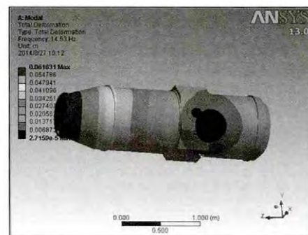
图6 镜筒第一阶固有频率
